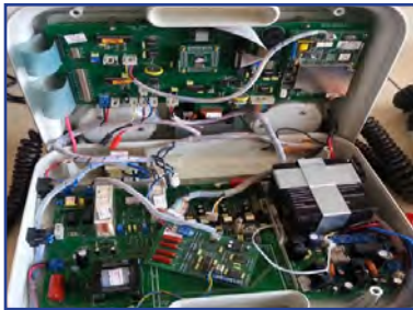
Görsel 7.2: Defibrilatör cihazı iç yapısı
