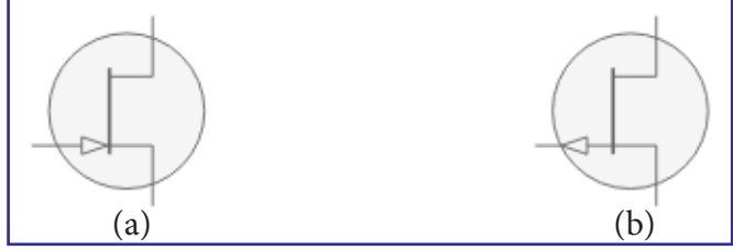
Görsel 6.18: N-kanallı JFET sembolü (a), p-kanallı JFET sembolü (b)
