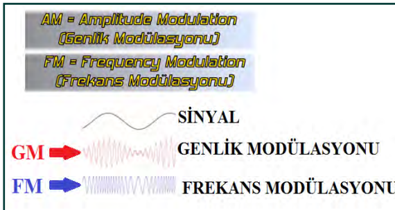
Görsel 1.54: Bir sinyalin iletiminde kullanılan temel modülasyonlar
