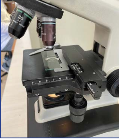
Görsel 2.12: Lam ve lamel tutucu mekanizma
