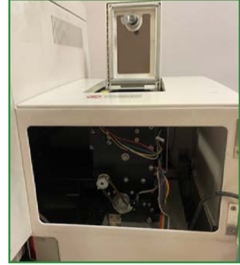
Görsel 4.8: Strip alma haznesindeki dişli ve kayış sistemi
