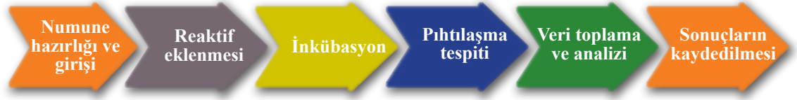
Şema 1.3: Koagülometre cihazıyla pıhtılaşma sürecinin ölçülmesi
