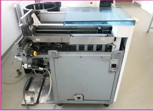
Görsel 10.15: Bazı mekanik ve hareketli bileşenleri ortaya çıkarılmış bir otoanalizör
