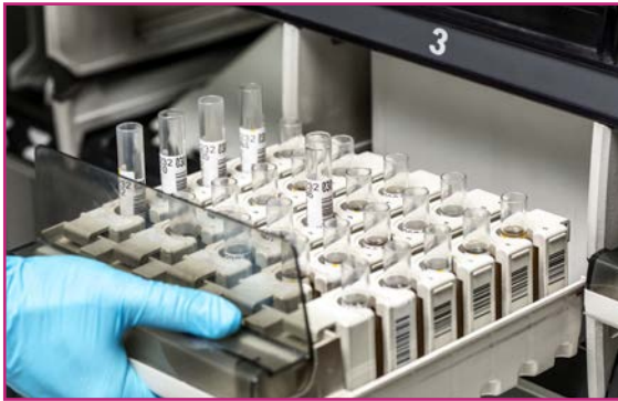
Görsel 10.6: Otoanalizörlerde kullanılan raklar
