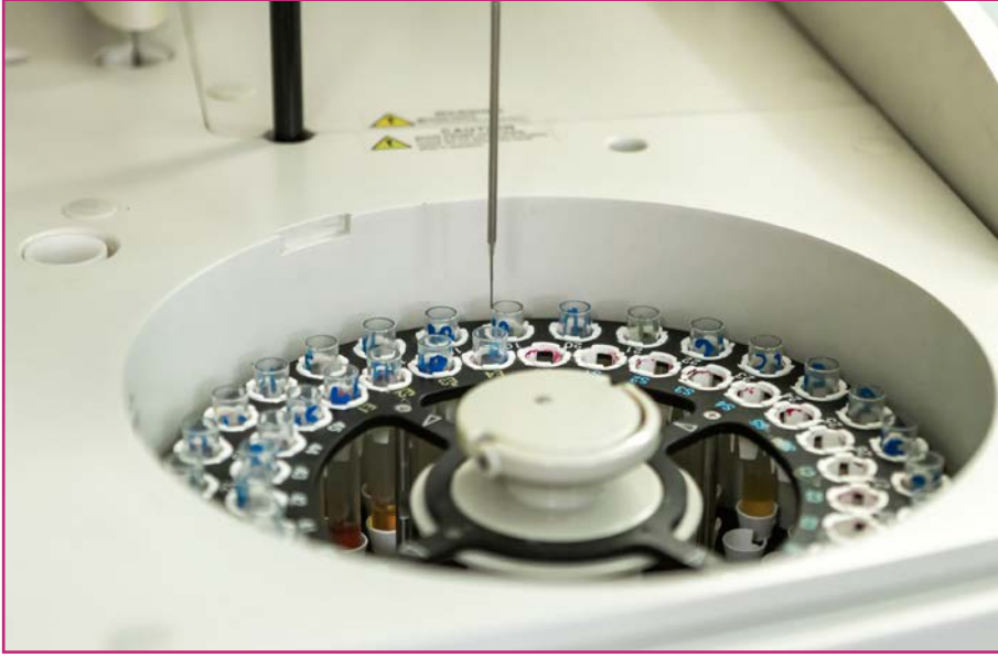
Görsel 10.19: Prop hareketinin test edilmesi
