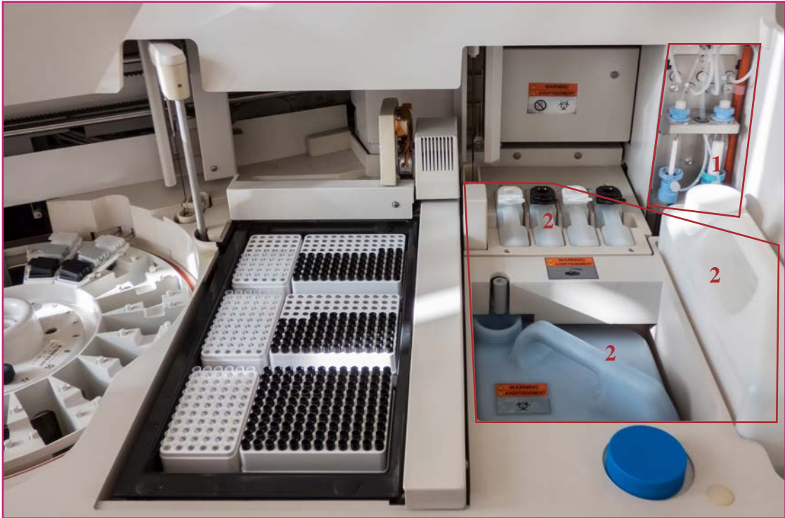
Görsel 10.14: Şırıngalar ve sıvı (yıkama sıvıları ve solüsyonlar) depolama sistemi
