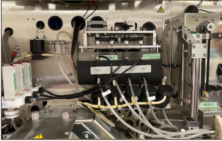
Görsel 7.6: Kan sayım cihazındaki pipetler
