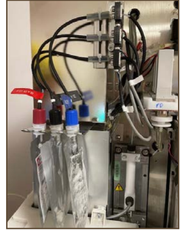
Görsel 7.7: Kan sayım cihazındaki pipetler
