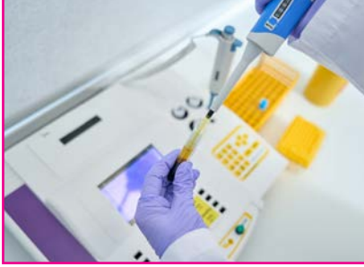
Görsel 1.12: Pipetle küvete reaktif aktarımı
