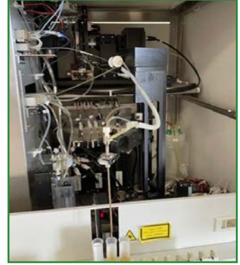
Görsel 4.13: Pipetleme ünitesi ve hareket mekanizması
