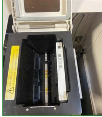
Görsel 4.7: Yuvasa yerleştirilmiş bir idrar stribi ve sağ tarafındaki metal tırnaklar
