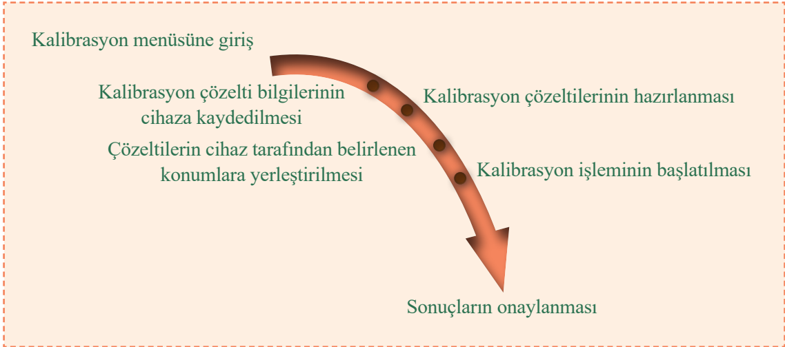
Şema 10.9: Biyokimya cihazlarının genel kalibrasyon adımları
