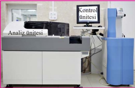
Görsel 10.3: Analiz ve kontrol ünitesi belirtilmiş bir otoanalizör
