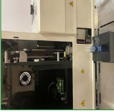
Görsel 4.4: Strip ünitesinde barkod okuyucu
