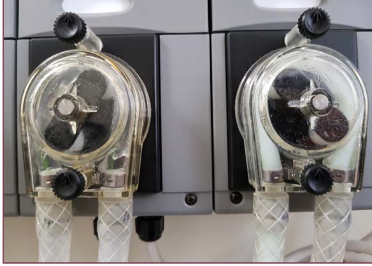
Görsel 3.9: Farklı boyutlarda peristaltik pompalar
