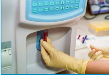
Görsel 8.17: Kan sayım cihazı numune aktarım birimi
