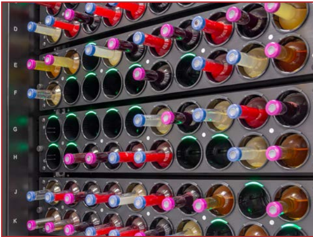
Görsel 5.5: Floresan teknolojiyle çalışan cihaza şişelerin yerleştirilmesi
