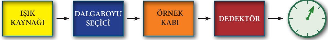
Şema 9.2: Spektrofotometri tekniğinin basitleştirilmiş mekanizması
