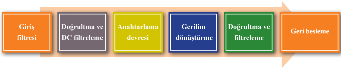
Şema 1.4: Anahtarlamalı besleme ünitesinde uygun gerilimin oluşması
