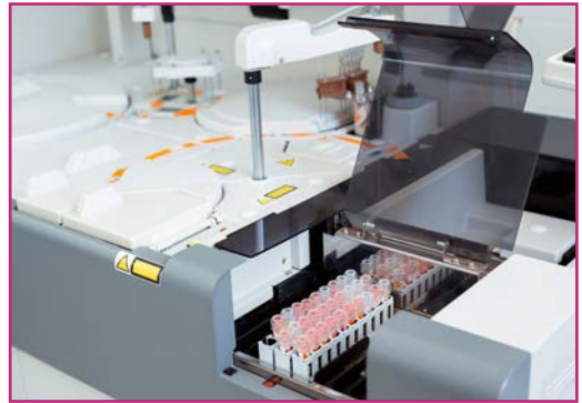
Görsel 10.7: Biyokimya cihazı otomatik rak yükleme sistemi
