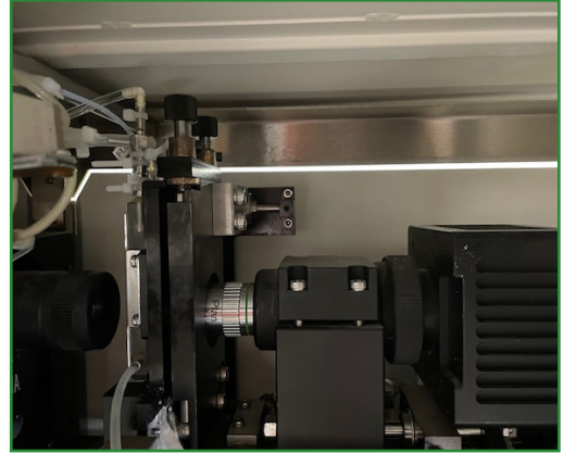
Görsel 4.10: Akış hücresinden geçirilen numunenin mikroskopla incelenmesi
