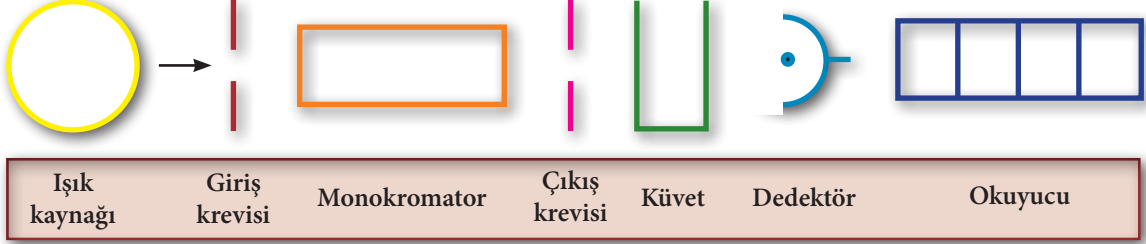
Şema 9.3: Tek yollu spektrofotometri yöntemi temel bileşenler diyagramı
