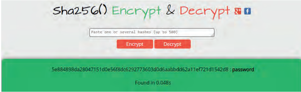
Görsel 5.13: SHA-256 ile üretilmiş ve bilinen hashlerden kelime elde edilmesi
