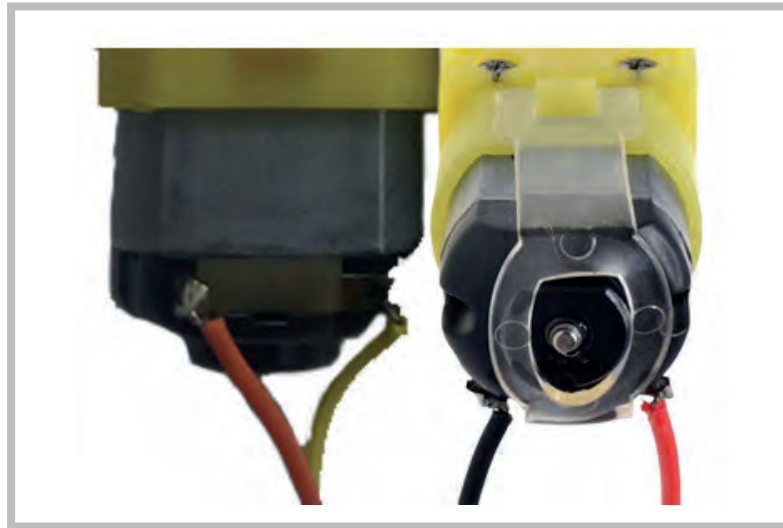
Görsel 3.13: Eğitsel robotun motor uçlarının lehimlenmesi
