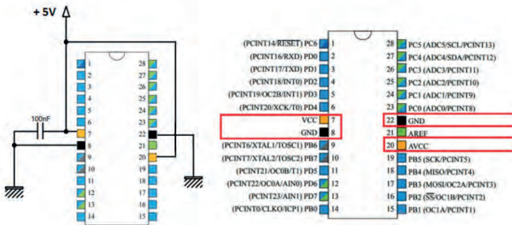
Görsel 2.16: Atmega328P besleme uçları ve bağlantıları
