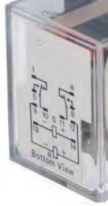
Görsel 3.41: Röle bobin ve kontak bağlantısı
