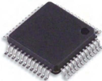
Görsel 7.19: QFP yapısında entegre
