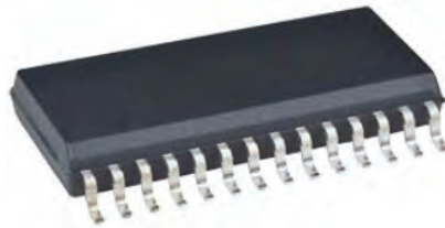
Görsel 7.17: TSOP kılıf yapısında entegreler
