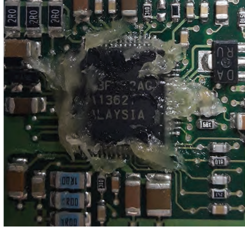
Görsel 7.36: Çipset üzerine flux sürülmesi
