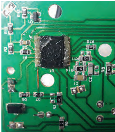
Görsel 7.22: SMD entegre üzerine flux sürülmesi
