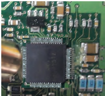
Görsel 7.44: Çipsetin üstten ısıtılması
