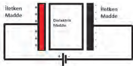
Görsel 1.16: Kondansatörün temel yapısı
