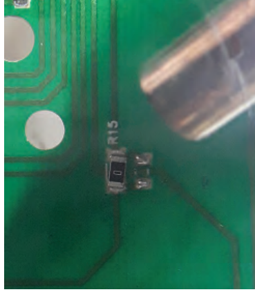
Görsel 7.13: SMD elemanın üstten ısıtılması
