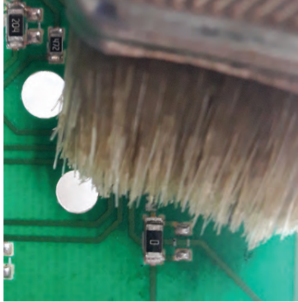
Görsel 7.14: SMD eleman ve baskı devre kartının temizlenmesi
