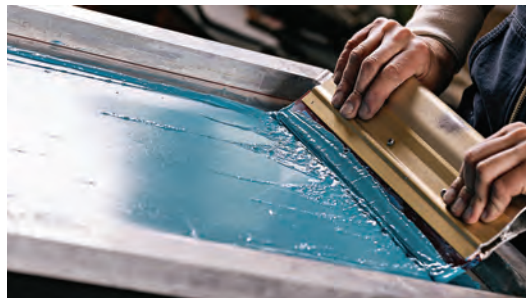
Görsel 5.20: Ragle ile ipek üzerinden boya çekilmesi
