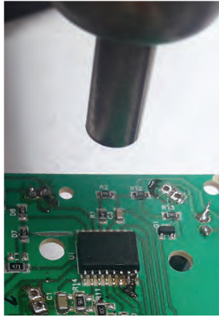
Görsel 7.23: SMD entegrenin üstten ısıtılması
