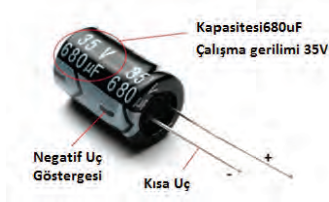
Görsel 1.28: Kondansatör etiket değerleri ve negatif uç göstergesi
