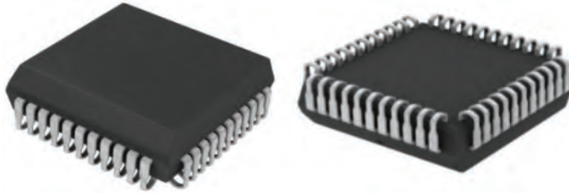
Görsel 7.18: PLCC kılıf yapısında entegre
