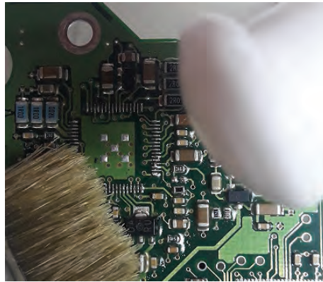
Görsel 7.40: Baskı devre kartının temizlenmesi
