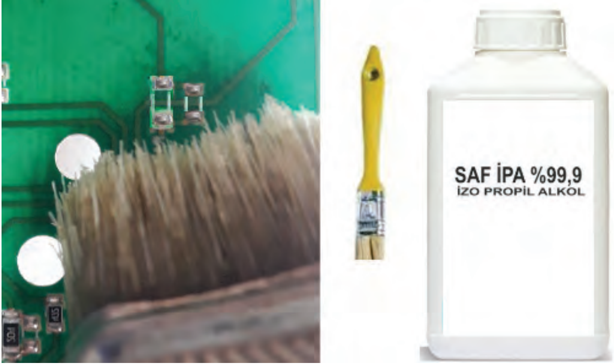
Görsel 7.8: Baskı devre kartının temizlenmesi
