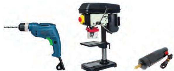
Görsel 5.25: a) El breyzi b) Tezgâh tipi matkap c) Elektronikçi hobi matkap
