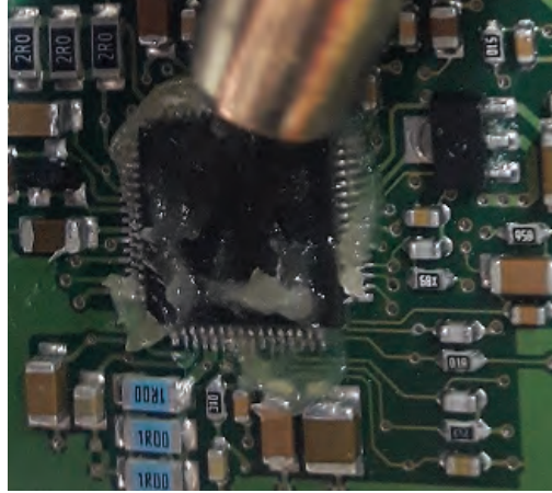
Görsel 7.37: Çipsetin üstten ısıtılması
