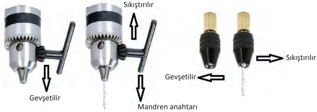
Görsel 5.28: Mandrene matkap ucunun yerleştirilmesi
