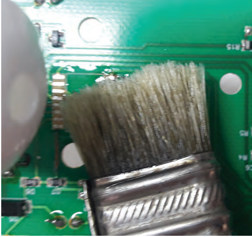
Görsel 7.26: Baskı devre kartının temizlenmesi
