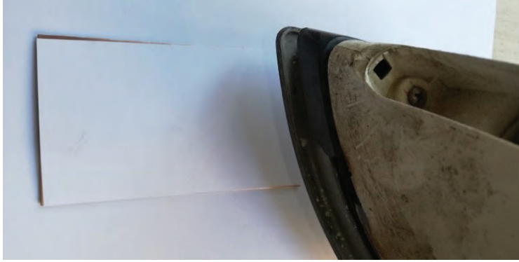
Görsel 6.4: Ütüleme işlemiyle görüntünün bakır plakete aktarılması
