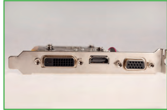
Görsel 3.18: Ekran kartı portları (Soldan sağa doğru: DVI, HDMI ve VGA portları)
