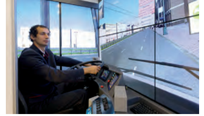
Görsel 2.14: Sürücü kurslarında kullanılan direksiyon simülasyon sistemleri
