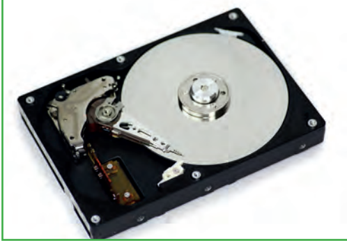
Görsel 3.24: Manyetik diskli sabit sürücü iç yapısı
