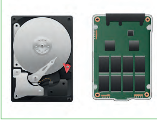
Görsel 3.26: SSD ve manyetik plakalı sabit sürücü iç yapısı
