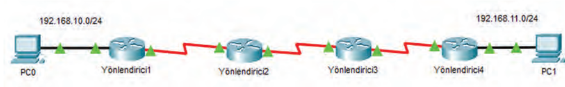
Görsel 5.5: Uzaklık vektörü ile bağlantı durum protokolleri için ağ topolojisi
