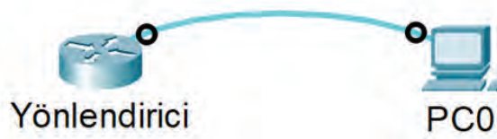
Görsel 3.3: Yönlendiricinin konsol kablosu ile bağlantısı
