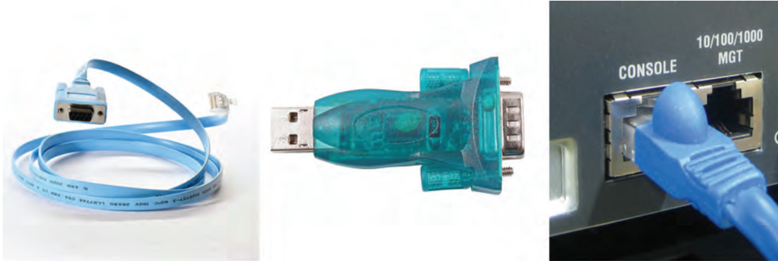
Görsel 3.1: Konsol kablosu ve dönüştürücü
