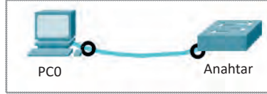
Görsel 6.18: Anahtarın konsol kablosu ile bağlantısı
