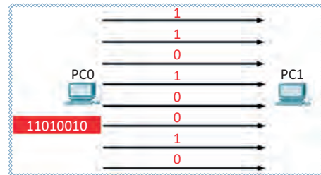
Görsel 1.4: Paralel iletişim hattında veri iletimi
