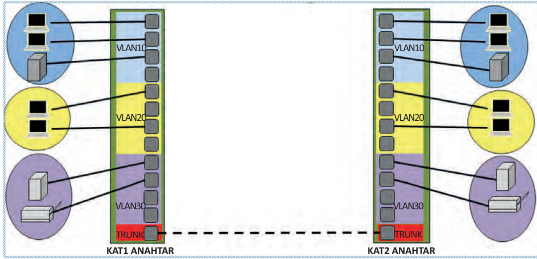
Görsel 7.20: Trunk ile anahtar cihazlar arasında bağlantı
