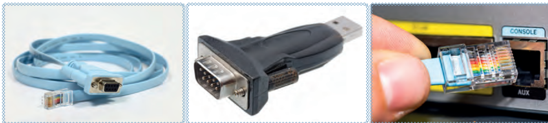
Görsel 6.3: Konsol kablosu ve dönüştürücü
