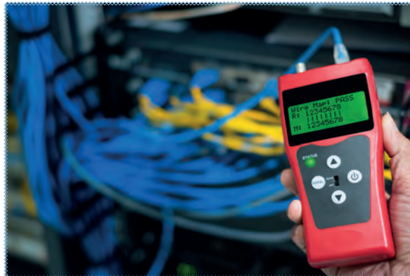
Görsel 2.6: Dijital kablo test cihazı ve kullanımı
