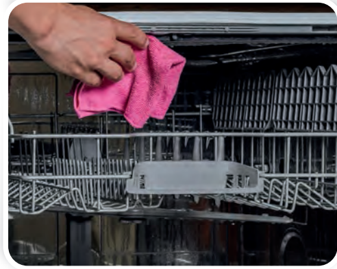
Görsel 5.75: Lastik ve kapağın temizlenmesi
