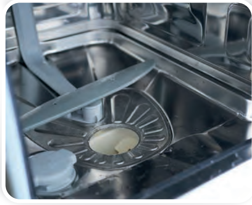
Görsel 5.45: Su biriktirme havzası, boru ve püskürtme kolları
