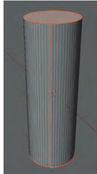
Görsel 3.199: Silindir nesnesinin açılacak kenarlarının belirlenmesi
