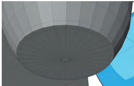
Görsel 3.156: Kısayol tuşlarını kullanarak nesnenin alt yüzeyinde yeni bir yüzey oluşturma
