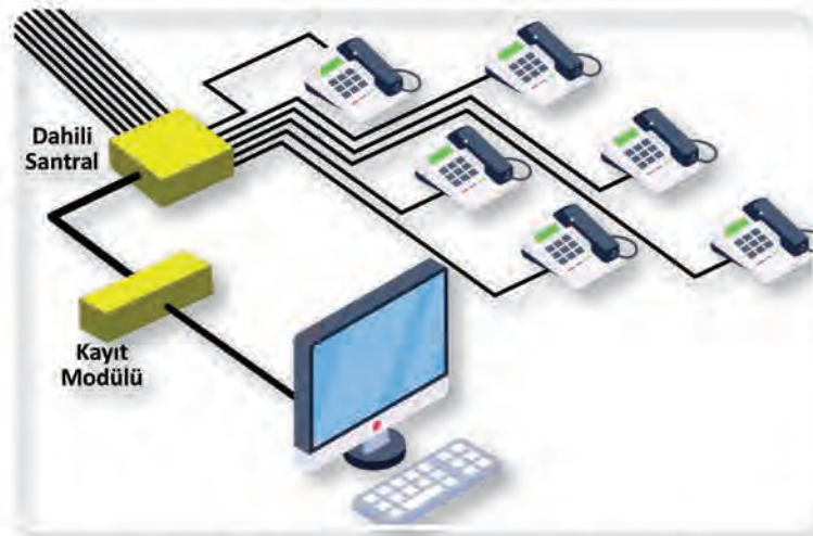
Görsel 1.49: Telefon kayıt sistemi yapısı ve bağlantıları
