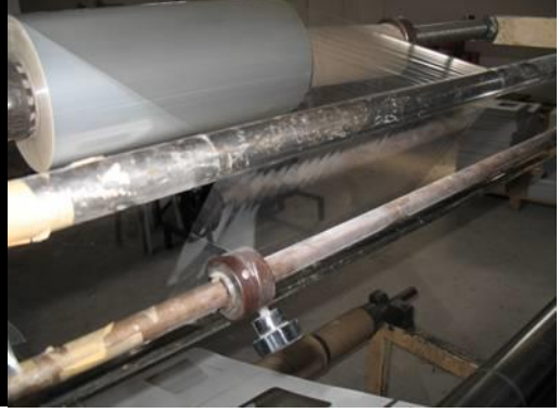
Resim 1.36 : Tam sefona kaplamada sefona akış yolu (Tutkal haznesi içinden geçer.)
