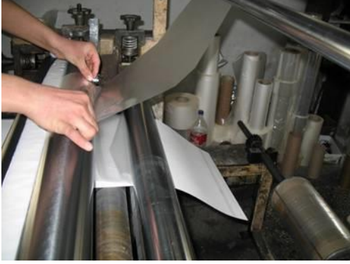
Resim 1.35: Pencerele sefona kaplamada sefona akış yolu (Takıldığı yerden makaralar ile presyona girer.)
