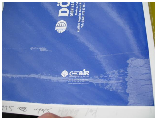
Resim 3.29 : Kat izi oluşumu
