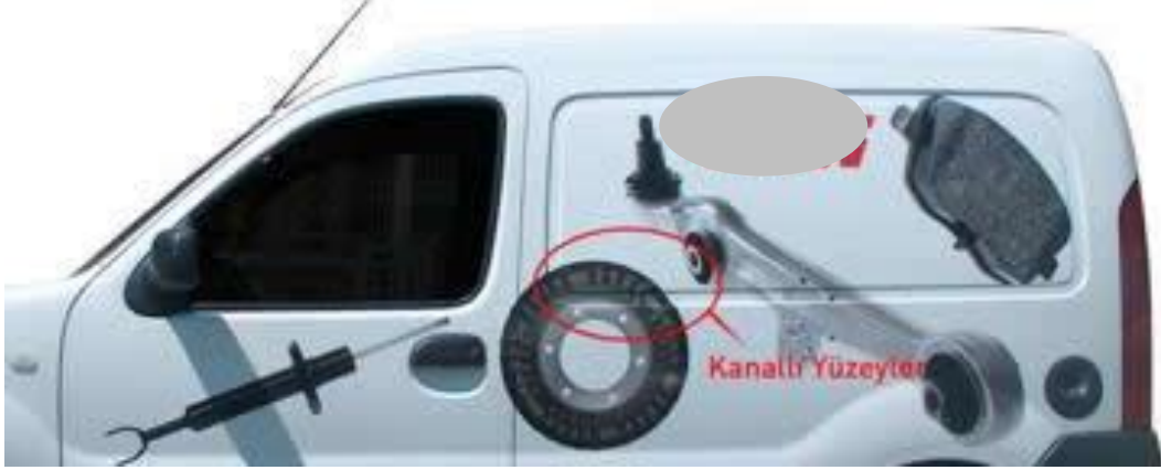
Resim 2.5: Kanallı yüzeye cast folyo giydirmesi
