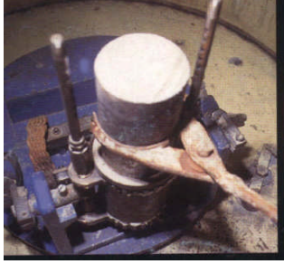
Resim 3.1: Derecenin santrifüj döküm makinesine yerleştirilmesi
