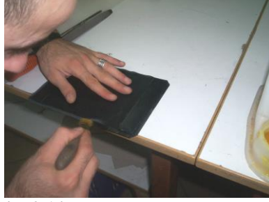
Resim 2.14: Kıvrımlık yapıştırıcı sürme
