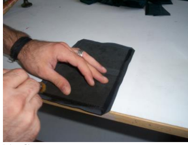
Resim 2.11: Gövde kenarlarına yapıştırıcı sürülmesi
