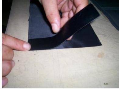
Resim 2.6:Astar ile yan parçanın birleştirilmesi
